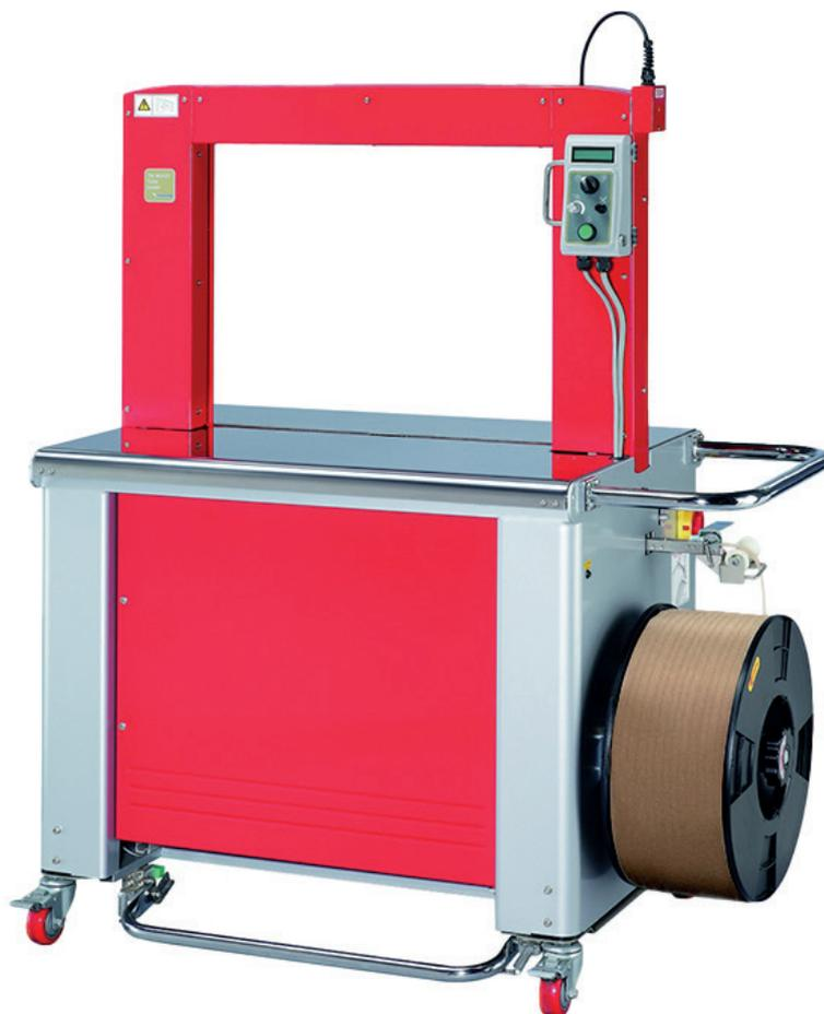
La cercluse automatique LC702 permet d'utiliser du cerclage polypropylène et du cerclage papier en 12mm.
