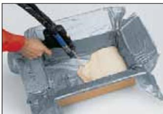
1. La mousse Instapak® est injectée dans le carton sur un film de polyéthylène Instamate® haute performance.
