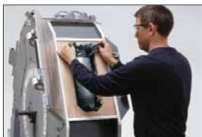
2. L'opérateur place le sachet rempli de mousse en expansion dans le moule où il est retenu à l'aide d'un aspirateur.
