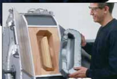
3. Lorsque l'expansion de la mousse est finie, l'opérateur retire la cale grâce à un système interne d'éjection.
