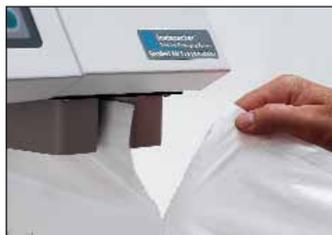
2. Retirez le sachet avec la mousse en expansion en coupant les perforations.
