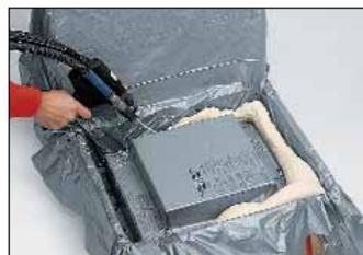
3. Une feuille de film Instamate® est placée dans le moule puis on injecte de la mousse Instapak®.
