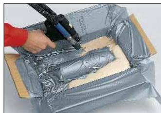
3. Un second film Instamate® est placé sur le produit et on réinjecte de la mousse Instapak®.
