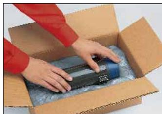
2. Le film Instamate® est rabattu et le produit est placé sur la mousse en expansion.
