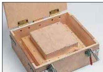
2. Un simple moule en bois avec l'empreinte du produit est utilisé pour la réalisation de la cale.
